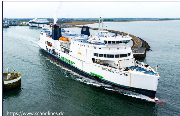
Umrüstung Fähren „Deutschland“ und „Schleswig-Holstein“ auf 80% batterieelektrischen Betrieb (Scandlines)
