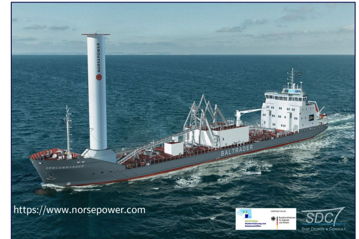
Ausrüstung „Cemcommander“ mit einem Rotorsegel. (BRISE Bereederung)
