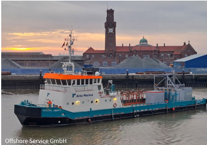
Umbau des OSV „Coastal Liberty“ mit H2-Power Unit (Offshore Service GmbH)
