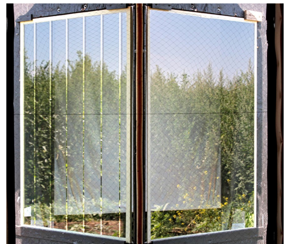
Arnold Glas Ornilyx® design lines 5/95: hoch wirksame Metallmarkierung mit klassischem Streifenmuster (links Prüf-, rechts Referenzscheibe).
